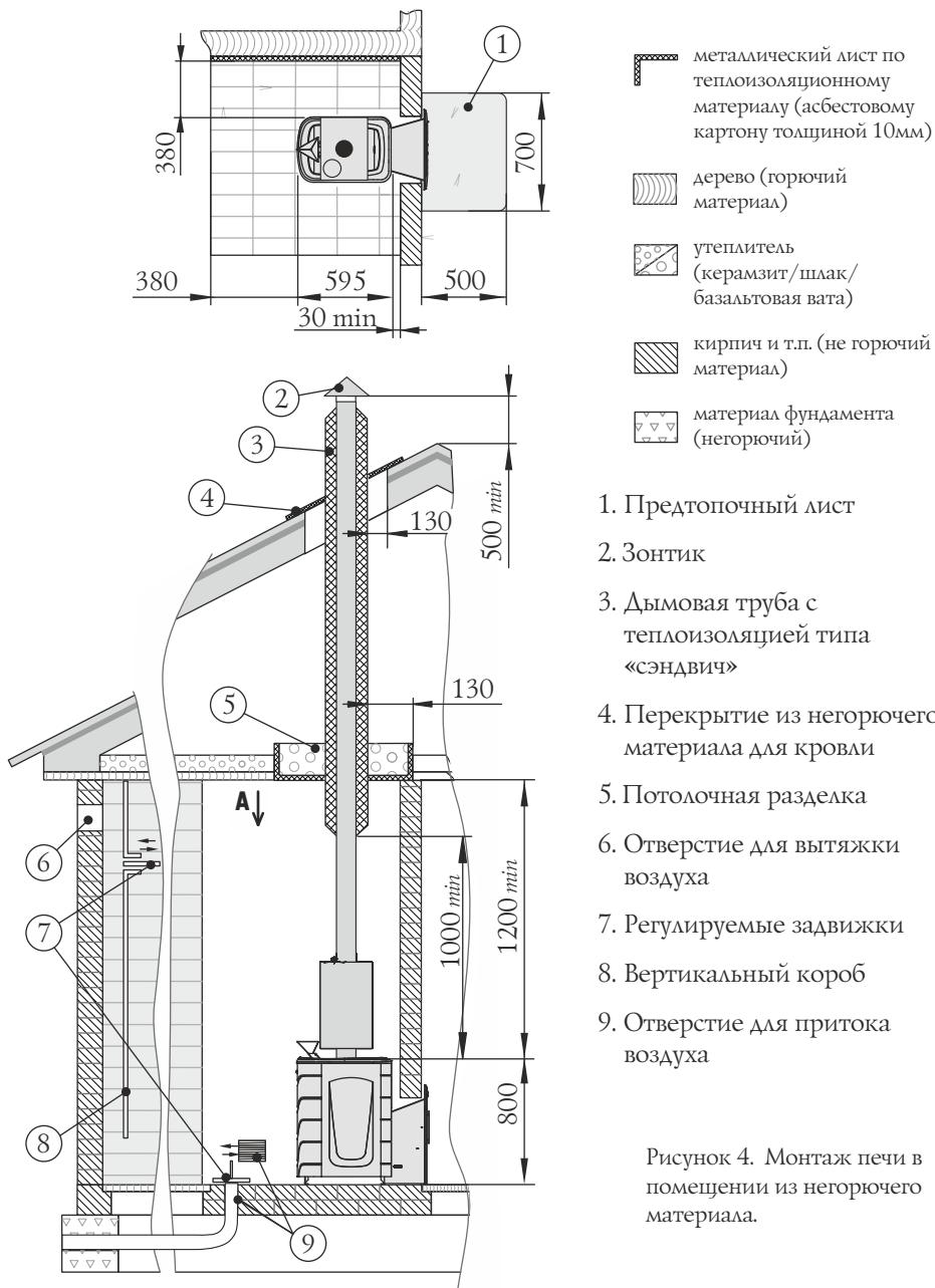
Рисунок 4. Монтаж печи в помещении из негорючего материала.
