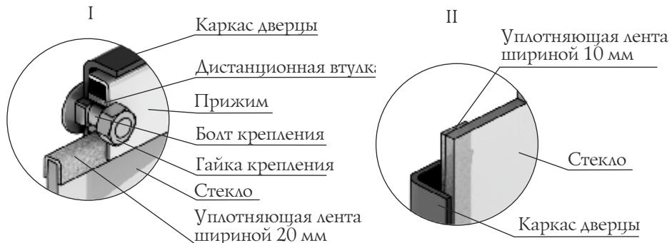
Рисунок 15. Крепление светорозрачного экрана дверцы модели «Витра»
