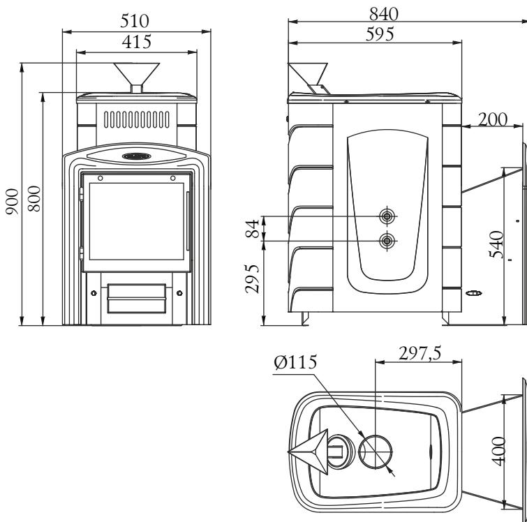
Рисунок 2. Габаритные размеры печи «Гейзер 2014 Витра».
