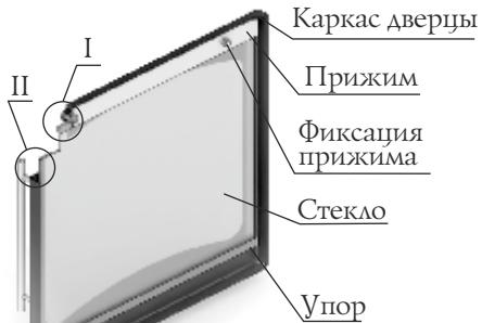
Рисунок 14. Ремонт светорозрачного экрана дверцы модели «Витра»
