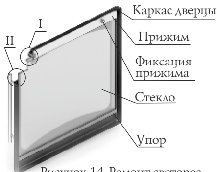
Рисунок 14. Ремонт светопрозрачного экрана дверцы модели «Витра»
