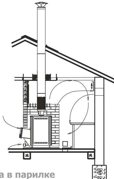
Рис. 4. Схема воздухообмена в парилке
