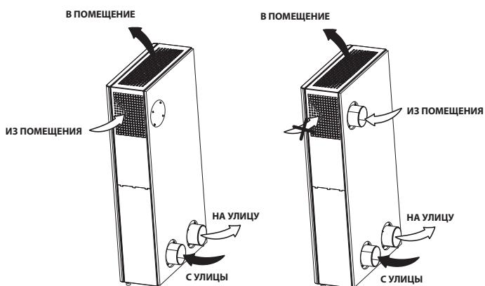
В установке предусмотрен монтаж вытяжного патрубка ( $\varnothing 100 \text{ mm}$ ) для обслуживания другого помещения, например, ванной комнаты. Патрубок входит в комплект поставки. Вытяжная решетка должна быть закрыта магнитной заглушкой, входящей в комплект поставки (см. раздел "Монтаж и подготовка к работе").
