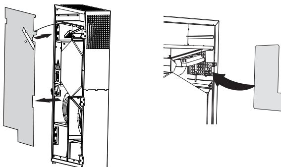
Поднимите установку, вставьте патрубки в соответствующие установленные в стене воздуховоды. Наклон воздуховодов должен быть минимум 3 мм.
