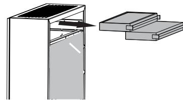
Если установлен вытяжной патрубок, снимите верхнюю защитную панель и установите магнитную заглушку на вытяжную решетку.
