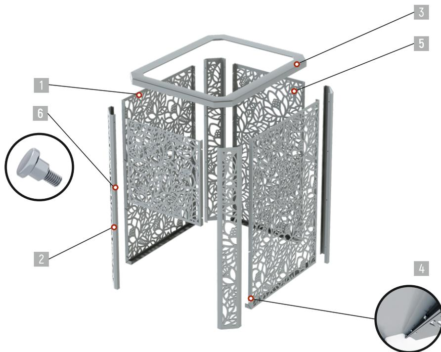
Рис. 3 Схема сборки защитного кожуха
