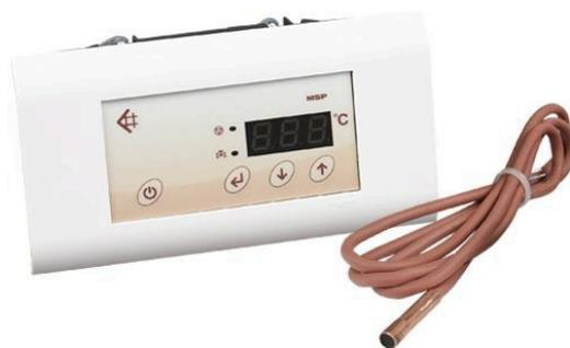
Кроме основных функций контроллер сообщает о превышении аварийного уровня температуры, защищает контур от замерзания, автоматически включая насос центрального отопления в случае перепада измеряемой температуры ниже 4°C, а также самостоятельного выхода с состояния спящего режима при обнаружении повышения температуры жидкости в установке.
