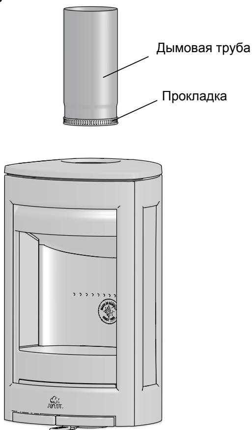
1. Наложите уплотнительную прокладку на нижнюю часть дымовой трубы.
