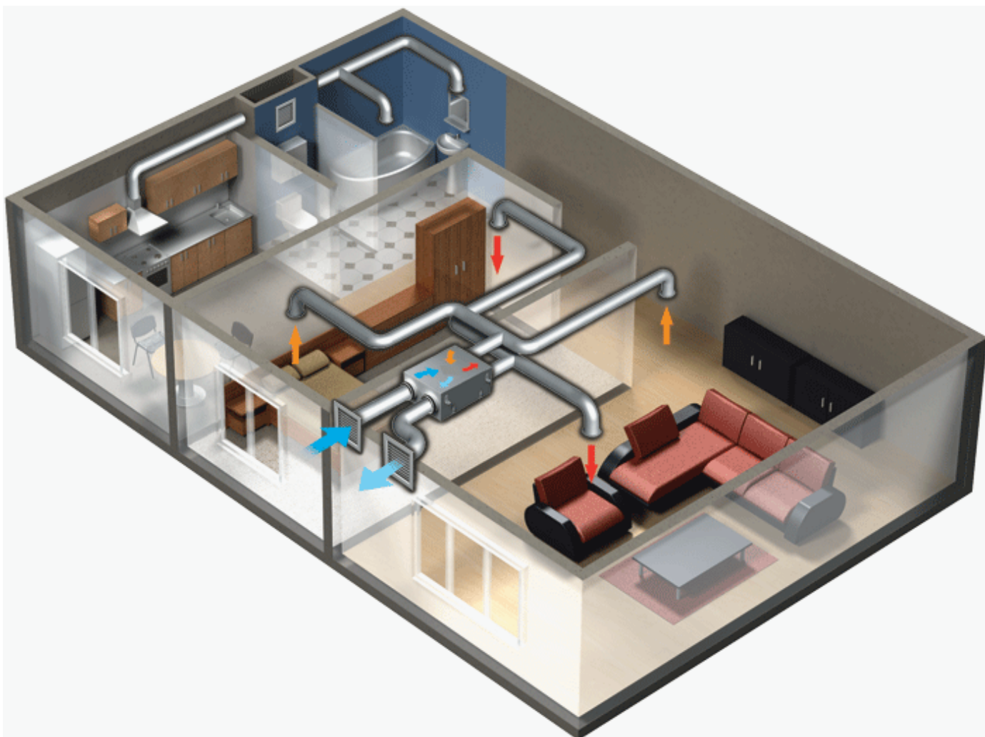
Монтаж ВЕНТС ВУЭ 100 П мини в квартире
